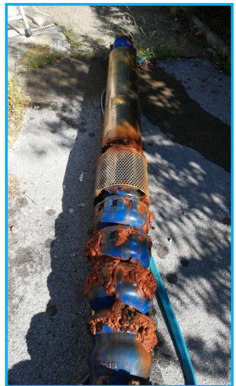
Castelnau-le-Lez – La Crouzette : pompe d'exhaure forage F3
